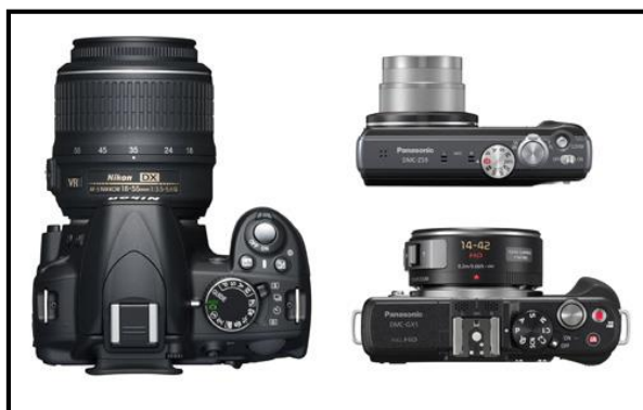
شكل (16) يوضح الفارق في الحجم ما بين كل من كاميرات التصوير الرقمية العاكسة ذات العدسة الواحدة وكاميرات التصوير الرقمية بدون مرآة.
